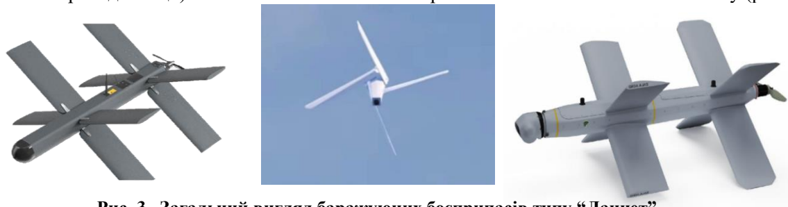
Рис. 3. Загальний вигляд баражуючих боєприпасів типу “Ланцет” (зліва – “Ланцет-1”, “Скальпель”, у центрі – “Изделие 53”, справа – “Ланцет-3”)
