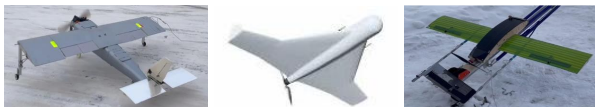
Рис. 4. Загальний вигляд баражуючих боєприпасів літакового типу (зліва – “Привет-120”, у центрі – “Куб”, справа – “Привет-82”)
