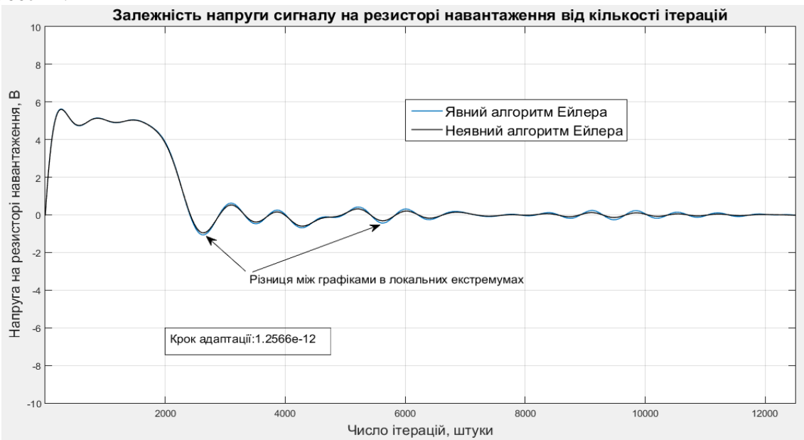
Рис. 6. Залежність напруги сигналу на резисторі навантаження для обох алгоритмів при розмірі кроку налаштування 1.2566e-12
