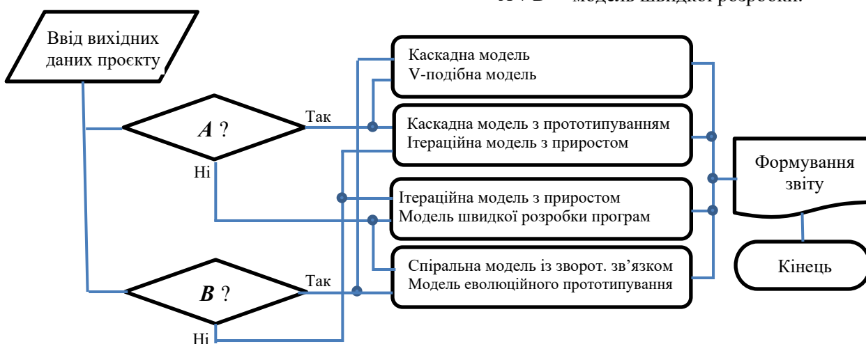
Рис. 4. Алгоритм вибору моделі життєвого циклу ПЗ
