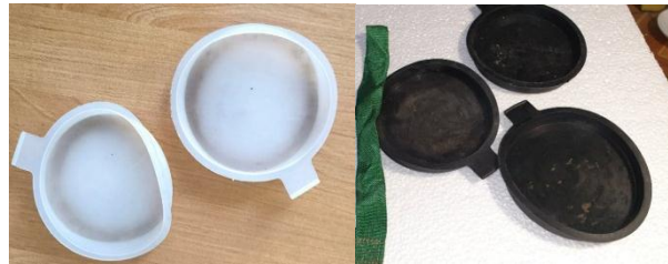
Рис. 5. Заглушки гнізд для встановлення детонаторів
