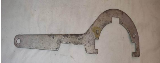
Рис. 3. Ключі для закручування детонаторів
