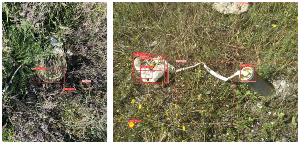
Рис. 7. Приклади розпізнавання із низькою ймовірністю побічних рукотворних артефактів поряд із міною
