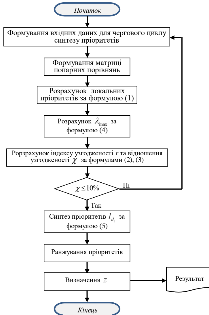
Рис. 3. Блок-схема алгоритму синтезу пріоритетів
