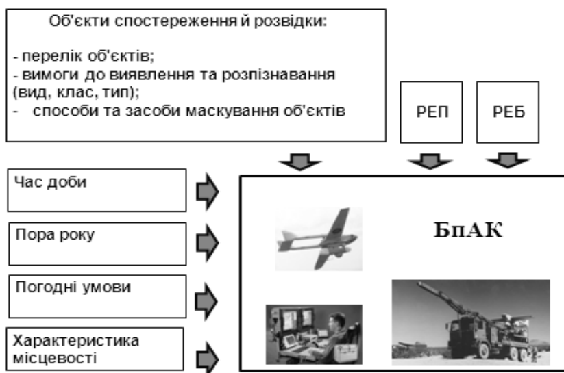
Рис. 3. Формування тактико-технічних вимог до БПЛА
