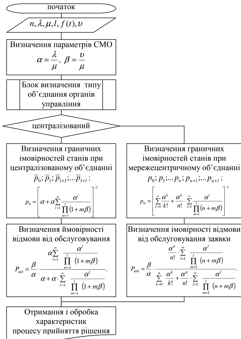
Рис. 5. Блок-схема удосконаленої моделі прийняття рішення
