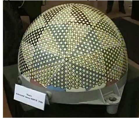
Рис. 1. Приклад багатосегментної конформної антенної решітки
