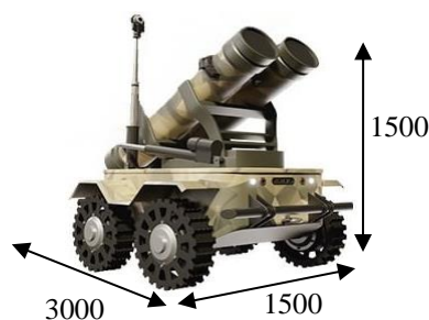
Рис. 2. Габаритні розміри НРЗРК з ракетами Р-73, мм
